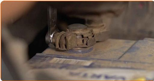
**4** Entfernen Sie die Batterieklammern.
