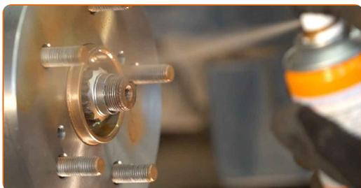
**17** Reinigen Sie die Oberfläche an welcher die Felge montiert werden soll. Benutzen Sie einen Bremsenreiniger.
