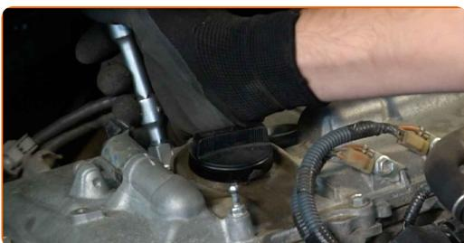
**13** Schrauben Sie die neuen Zündkerzen an und ziehen Sie diese fest. Verwenden Sie die Zündkerzennuss # 16. Verwenden Sie einen Drehmomentschlüssel. Ziehen Sie ihn mit 20 Nm Drehmoment fest.
