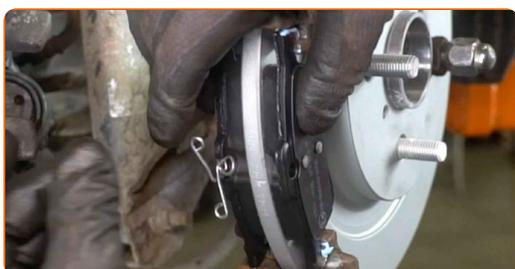
**28** Installieren Sie den Bremssattel und fixieren Sie diesen.
