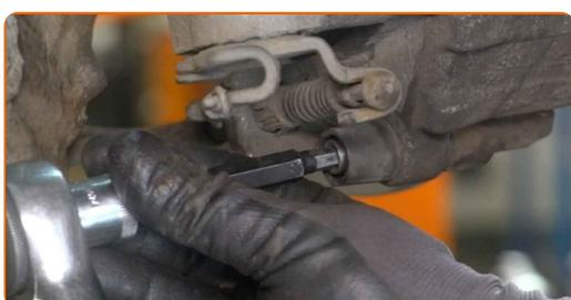
**30** Installieren Sie die Staubschutzkappen der Bremssattel-Führungsstifte.
