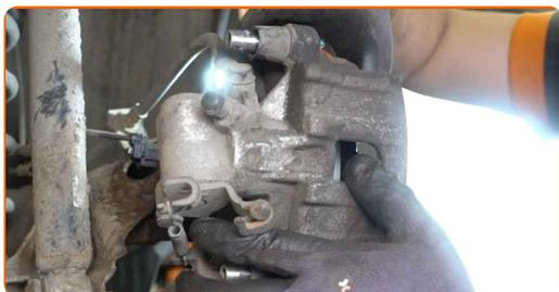
**29** Ziehen Sie die Bremssattelbefestigungen fest. Verwenden Sie Inbusschlüssel Nr. H7. Verwenden Sie einen Drehmomentschlüssel. Ziehen Sie ihn mit 28 Nm Drehmoment fest.
