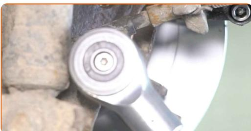
**24** Behandeln Sie den Bremssattel-Kolben. Verwenden Sie eine Nylon-Reinigungsbürste. Benutzen Sie einen Bremsenreiniger.
