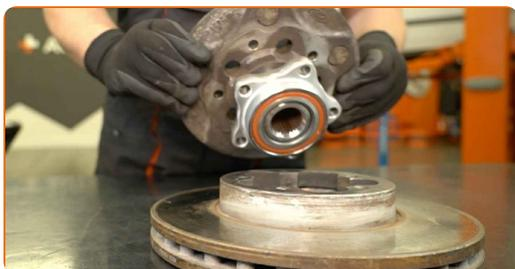
**42** Reinigen Sie die Oberfläche der Bremsscheibe, die mit der Radfelge in Kontakt ist. Benutzen Sie eine Drahtbürste.
