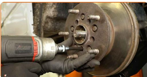
**31** Entfernen Sie die Befestigungsschrauben.
