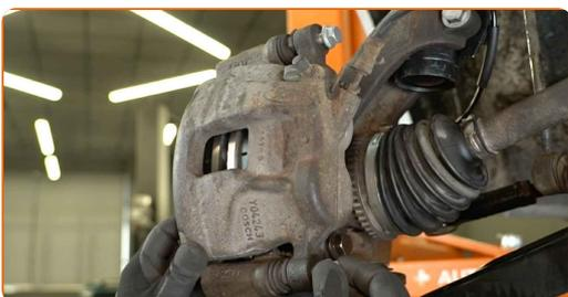
**62** Ziehen Sie die Befestigungsschrauben des Bremssattels fest. Verwenden Sie einen Ringmaulschlüssel mit einem Durchmesser von 21 mm. Verwenden Sie eine Stecknuss mit einem Durchmesser von 15 mm. Verwenden Sie einen Drehmomentschlüssel. Anzugsdrehmoment: 60 N·m.
