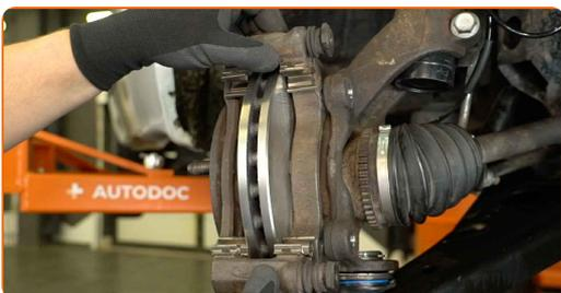
**53** Setzen Sie die Befestigungsschrauben ein.
