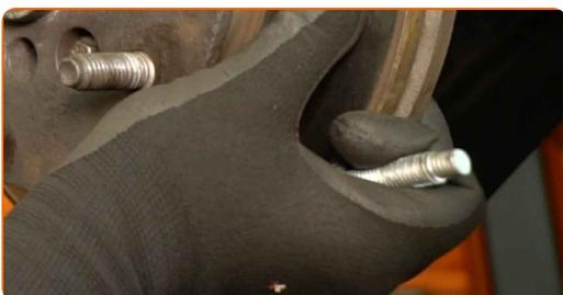
**32** Entfernen Sie die Radnabe zusammen mit der Bremsscheibe.
