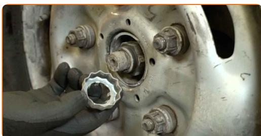
**8** Reinigen Sie die Achsmutter. Benutzen Sie eine Drahtbürste. Verwenden Sie WD-40-Spray.
