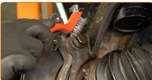
**27** Schrauben Sie die Befestigungsschrauben des Bremssattelträgers ab. Verwenden Sie eine Stecknuss mit einem Durchmesser von 18 mm. Verwenden Sie einen Drehstift.
