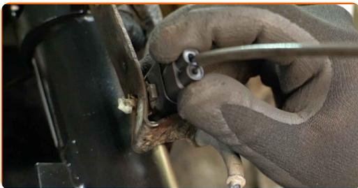
**59** Befestigen Sie den Bremsbelagfühler am inneren Bremsbelag.
