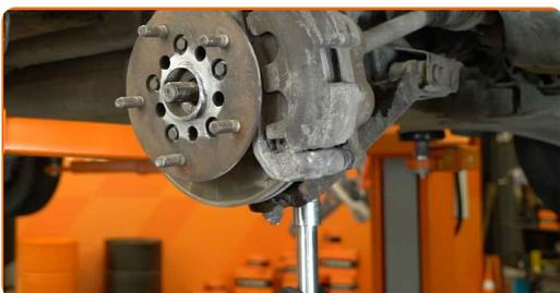
**16** Lösen Sie die Antriebswelle vom Achsschenkel. Verwenden Sie einen Splinttreiber. Verwenden Sie einen Hammer.
