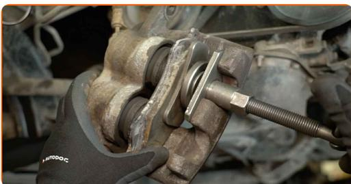
**52** Montieren Sie den Bremssattelträger.
