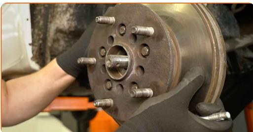
**33** Reinigen Sie die Radlageraufnahme. Benutzen Sie eine Drahtbürste. Verwenden Sie ein Allzweck-Reinigungsspray.
