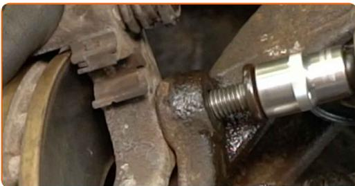
**29** Entfernen Sie den Bremssattelträger.
