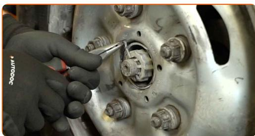
**7** Entfernen Sie die Schutzkappe von der Achsmutter.
