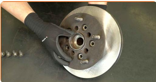
**44** Setzen Sie die Befestigungsschrauben ein.
