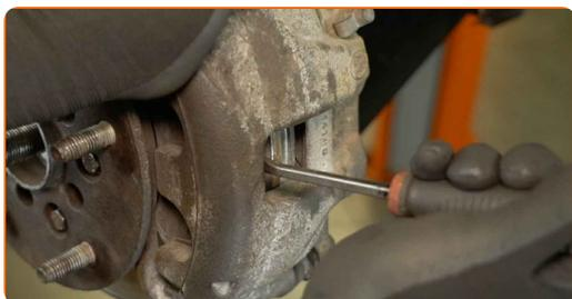
**19** Reinigen Sie die Befestigungsschrauben des Bremssattels. Benutzen Sie eine Drahtbürste. Verwenden Sie WD-40-Spray.
