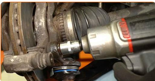
**28** Entfernen Sie die Befestigungsschrauben.
