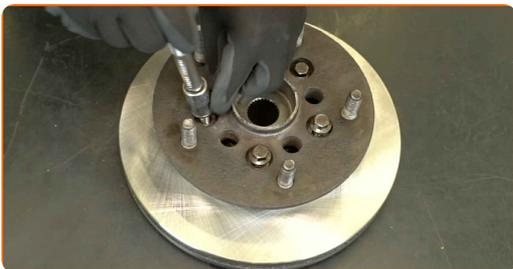
**45** Schrauben Sie die Befestigungsschrauben der Bremsscheibe ein. Verwenden Sie eine Stecknuss mit einem Durchmesser von 13 mm. Verwenden Sie einen Ratschenschlüssel.
