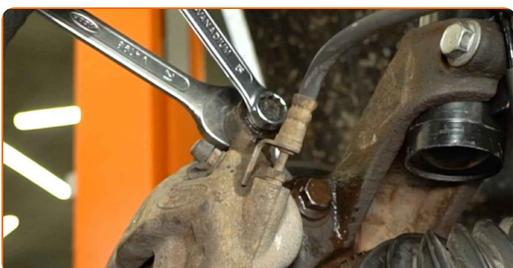
**11** Entfernen Sie die Befestigungsschrauben.
