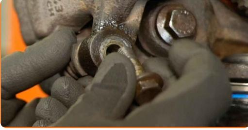
**12** Entfernen Sie den Bremssattel.
