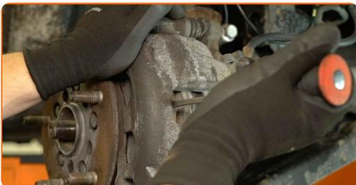
**17** Reinigen Sie die Befestigungsschrauben des Bremssattelträgers. Benutzen Sie eine Drahtbürste. Verwenden Sie WD-40-Spray.
