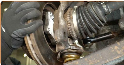
**42** Setzen Sie die Befestigungsschrauben ein.
