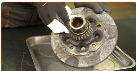
**34** Drücken Sie die Nabe aus dem Innenring des Lagers. Verwenden Sie einen Druckstücksatz. Verwenden Sie einen Lagertrenner und eine hydraulische Presse.
