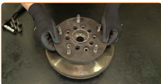
**38** Setzen Sie die Befestigungsschrauben ein.
