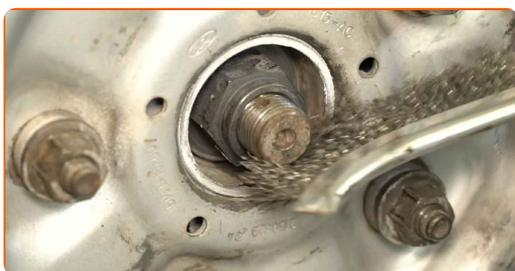
**7** Lockern Sie die Achsmutter. Verwenden Sie eine Stecknuss mit einem Durchmesser von 36 mm. Verwenden Sie einen Drehstift.
