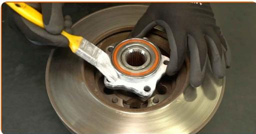
**41** Montieren Sie die Radnabe zusammen mit der Bremsscheibe.
