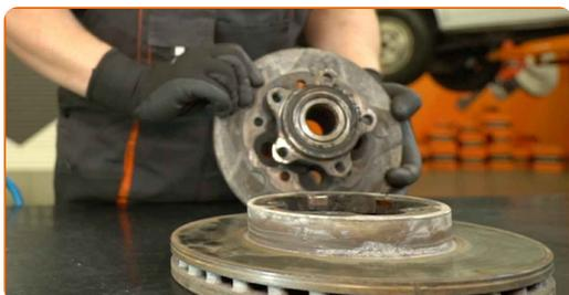
**31** Reinigen Sie die Oberfläche der Bremsscheibe, die mit der Radfelge in Kontakt ist. Benutzen Sie eine Drahtbürste.
