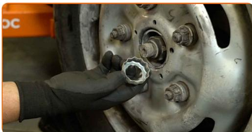
**6** Reinigen Sie die Achsmutter. Benutzen Sie eine Drahtbürste. Verwenden Sie WD-40-Spray.
