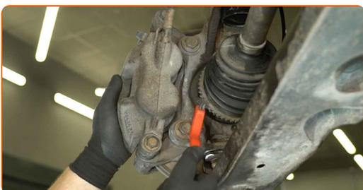
**18** Schrauben Sie die Befestigungsschrauben des Bremssattelträgers ab. Verwenden Sie eine Stecknuss mit einem Durchmesser von 18 mm. Verwenden Sie einen Drehstift.
