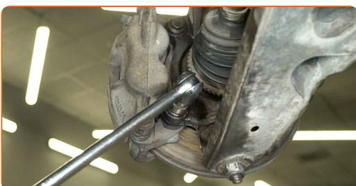
**19** Entfernen Sie die Befestigungsschrauben. Verwenden Sie einen Ratschenschlüssel.
