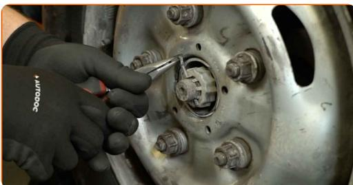
**5** Entfernen Sie die Schutzkappe von der Achsmutter.
