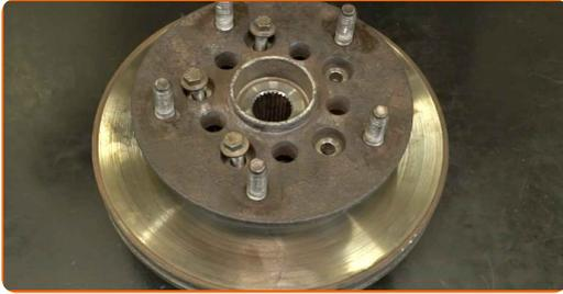
**39** Schrauben Sie die Befestigungsschrauben der Bremsscheibe ein. Verwenden Sie eine Stecknuss mit einem Durchmesser von 13 mm. Verwenden Sie einen Ratschenschlüssel.
