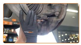
Schrauben Sie das Befestigungselement ein, das das Kugelgelenk mit dem Achsschenkel verbindet. Verwenden Sie Stecknuss Nr. 19. Verwenden Sie einen Ratschenschlüssel.
