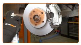
Die Bremsscheibenoberfläche reinigen. Benutzen Sie einen Bremsenreiniger.
