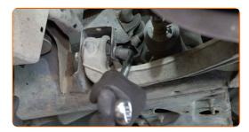
Ziehen Sie das vordere Befestigungselement an, das den Querlenker mit dem Hilfsrahmen verbindet. Verwenden Sie Ring-Gabelschlüssel Nr. 21. Verwenden Sie einen Drehmomentschlüssel. Ziehen Sie ihn mit 110 Nm Drehmoment fest.+120°
