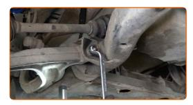
Schrauben Sie das hintere Befestigungselement ein, das den Querlenker mit dem Hilfsrahmen verbindet. Verwenden Sie Ring-Gabelschlüssel Nr. 21.
