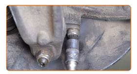
Lösen Sie das Befestigungselement, welches das Kugelgelenk am Federungsquerlenker befestigt. Verwenden Sie Stecknuss Nr. 21. Verwenden Sie einen Ratschenschlüssel.
