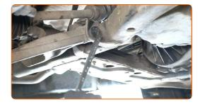
Schrauben Sie das hintere Befestigungselement heraus, das den Querlenker mit dem Hilfsrahmen verbindet. Verwenden Sie Ring-Gabelschlüssel Nr. 21.
