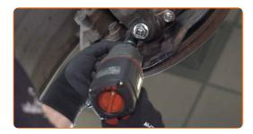
Schrauben Sie das Befestigungselement ein, das das Traggelenk mit dem Querlenker verbindet. Verwenden Sie Stecknuss Nr. 21. Verwenden Sie einen Ratschenschlüssel.
