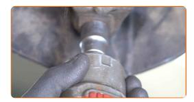
Schrauben Sie die vordere Armbefestigung ab. Verwenden Sie Ring-Gabelschlüssel Nr. 21.
