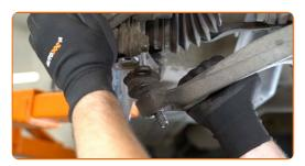
Entfernen Sie das Kugelgelenk. Verwenden Sie einen Kugelgelenkabzieher.
