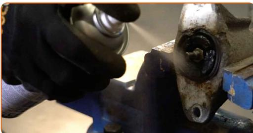
**15** Entfernen Sie die Befestigung der Stoßdämpferkolbenstange. Verwenden Sie Ring-Gabelschlüssel Nr. 13. Verwenden Sie einen Stoßdämpfer Steckschlüsseleinsatz DDN<sup>4</sup>. Verwenden Sie einen Ratschenschlüssel.
