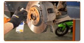
Die Bremsscheibenoberfläche reinigen. Benutzen Sie einen Bremsenreiniger.
