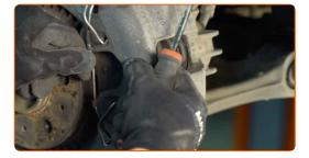
11 Entfernen Sie den Bremssattel.
