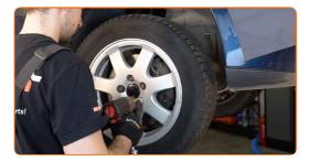
Senken Sie das Auto und ziehen Sie die Radschrauben über Kreuz an. Verwenden Sie einen Drehmomentschlüssel. Ziehen Sie ihn mit 140 Nm Drehmoment fest.
