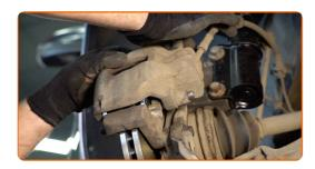
Installieren Sie die Staubschutzkappen der Bremssattel-Führungsstifte.
