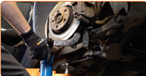
**16** Entfernen Sie die Befestigungsschrauben.
