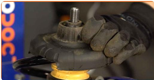
**36** Schrauben Sie das Befestigungselement des Federbeinstützlagers ein. Verwenden Sie Inbusschlüssel Nr. H6. Verwenden Sie einen Ratschenschlüssel. Verwenden Sie eine Wasserpumpenzange.
