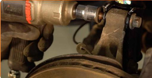
**45** Ziehen Sie die unteren Befestigungen an, die das Federbein mit dem Achsschenkel verbinden. Verwenden Sie Ring-Gabelschlüssel Nr. 18. Verwenden Sie Stecknuss Nr. 21. Verwenden Sie einen Drehmomentschlüssel. Ziehen Sie ihn mit 105 Nm Drehmoment fest.+60°
