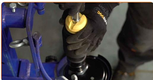
**31** Installieren Sie die Feder am Stoßdämpfer.
