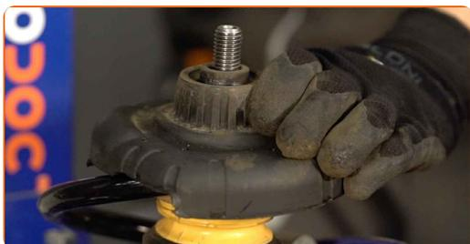
**34** Schrauben Sie das Befestigungselement des Federbeinstützlagers ein. Verwenden Sie Inbusschlüssel Nr. H6. Verwenden Sie einen Ratschenschlüssel. Verwenden Sie eine Wasserpumpenzange.
