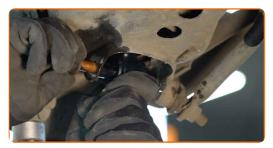
Schrauben Sie das untere Befestigungselement des Stoßdämpfers ein. Verwenden Sie Stecknuss Nr. 18.
