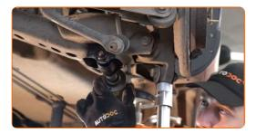
Ziehen Sie die obere Stoßdämpferbefestigung an. Verwenden Sie Ring-Gabelschlüssel Nr. 18. Verwenden Sie Stecknuss Nr. 18. Verwenden Sie eine Gripzange. Verwenden Sie einen Drehmomentschlüssel. Ziehen Sie ihn mit 60 Nm Drehmoment fest.
