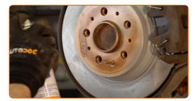
Die Bremsscheibenoberfläche reinigen. Benutzen Sie einen Bremsenreiniger.
