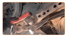
Schrauben Sie den unteren Befestiger des Stoßdämpfers ab. Verwenden Sie Stecknuss Nr. 18. Verwenden Sie ein Windeisen.
