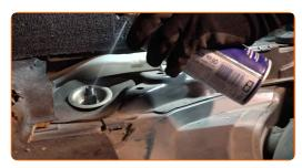
Drehen Sie das obere Befestigungselement des Stoßdämpfers auf. Verwenden Sie Ring-Gabelschlüssel Nr. 18. Verwenden Sie den Torx T30. Verwenden Sie einen Ratschenschlüssel.
