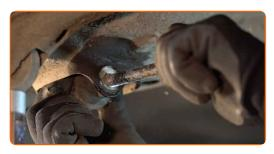
Den Stoßdämpfer entfernen. Benutzen Sie ein Brecheisen.
