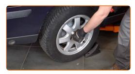
Entfernen Sie den Wagenheber sowie die Unterlegkeile.
