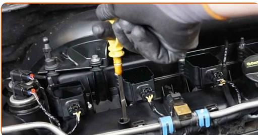
**4** Schrauben Sie die Öleinfüllschraube ab.
