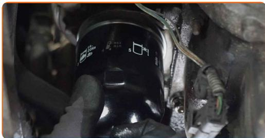
**16** Ziehen Sie die Befestigungselemente des Ölfilter fest. Denken Sie daran, das empfohlene Anzugsdrehmoment einzuhalten. Verwenden Sie Steckschlüssel 76-14F. Verwenden Sie einen Drehmomentschlüssel. Ziehen Sie ihn mit 17 Nm Drehmoment fest.
