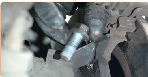
**17** Entfernen Sie den Bremssattelhalter.
