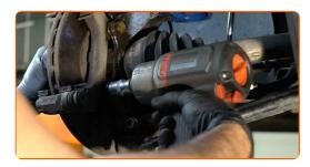
16 Entfernen Sie die Sattelhalterung
