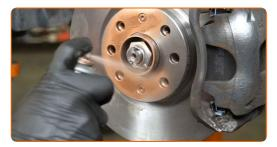
Die Bremsscheibenoberfläche reinigen. Benutzen Sie einen Bremsenreiniger.
