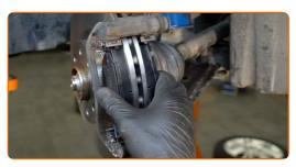
Installieren Sie den Bremssattel und fixieren Sie diesen. Verwenden Sie Stecknuss Nr. 13. Verwenden Sie einen Drehmomentschlüssel. Ziehen Sie ihn mit 30 Nm Drehmoment fest.
