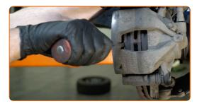
12 Entfernen Sie den Bremssattel.
