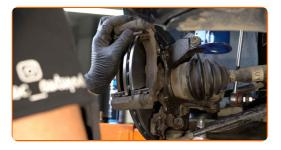
Befestigen Sie die Bremssattelhalterung. Verwenden Sie Stecknuss Nr. 19. Verwenden Sie einen Drehmomentschlüssel. Ziehen Sie ihn mit 105 Nm Drehmoment fest.
