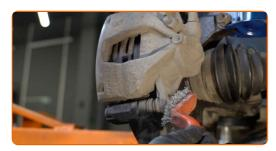
Schrauben Sie die Befestigung des Bremssattels ab. Verwenden Sie Stecknuss Nr. 13. Verwenden Sie einen Ratschenschlüssel.
