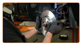
Ziehen Sie die Befestigung der Bremsscheibe fest. Verwenden Sie den Torx T30. Verwenden Sie einen Drehmomentschlüssel. Ziehen Sie ihn mit 7 Nm Drehmoment fest.
