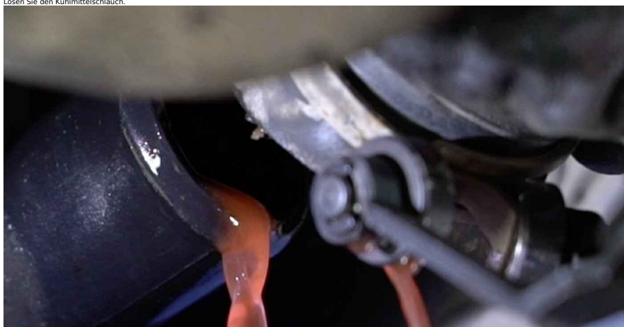
8 Lösen Sie den Kühlmittelschlauch.
