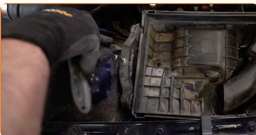
9 Entfernen Sie das Luftfiltergehäuse.
