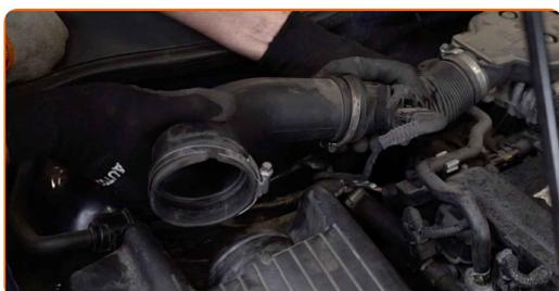
**38** Verbinden Sie das Luftansaugrohr mit dem Luftfilter-Gehäuse.
