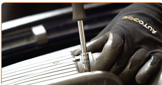
**40** Entfernen Sie die Kotflügel-Abdeckung.
