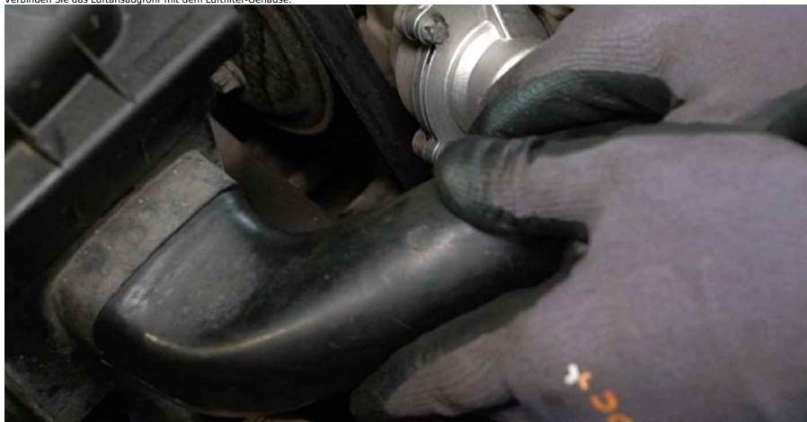
32 Bringen Sie die Klammer am Luftfilteransaugschlauch an.
