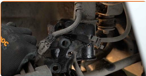
**27** Lösen Sie die obere Befestigung des Domlagers.
