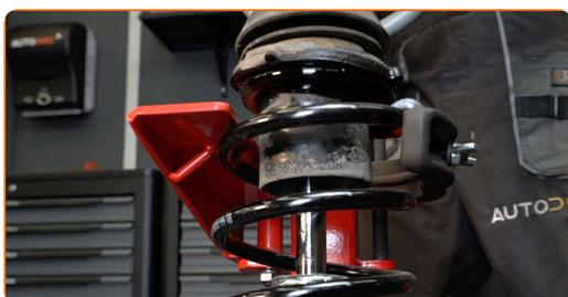
**43** Entfernen Sie das zusammengebaute Federbein.
