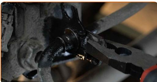
**21** Trennen Sie den Bremsschlauch.
