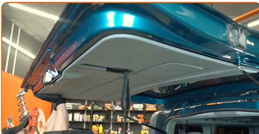
3 Schrauben Sie die Befestigungsmutter der dritten Bremsleuchte ab. Verwenden Sie eine Stecknuss mit einem Durchmesser von 8 mm. Verwenden Sie einen Ratschenschlüssel.
