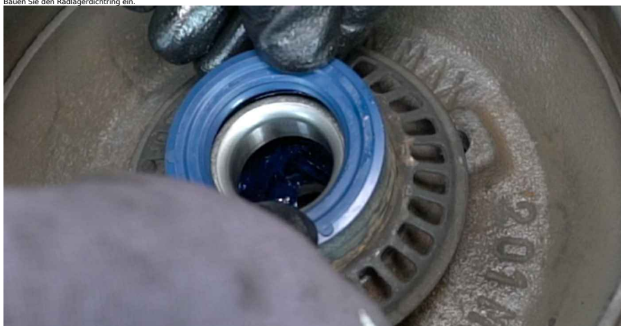
23 Behandeln Sie den Achszapfen. Verwenden Sie Allzweckreinigungsspray. Verwenden Sie Lagerfett.
