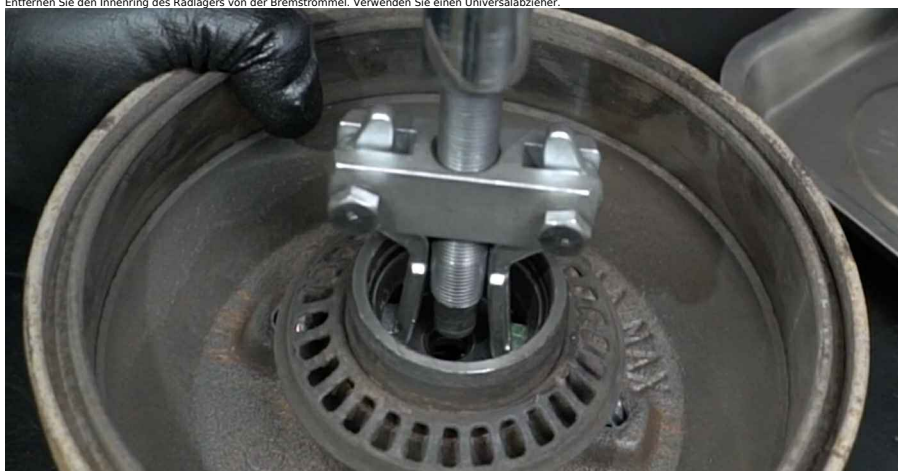
15 Entfernen Sie den Innenring des Radlagers von der Bremstrommel. Verwenden Sie einen Universalabzieher.
