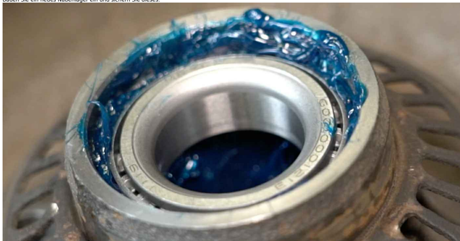
22 Bauen Sie den Radlagerdichtring ein.
