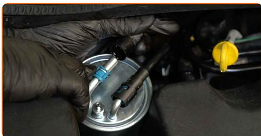
**14** Installieren Sie einen neuen Kraftstofffilter.
