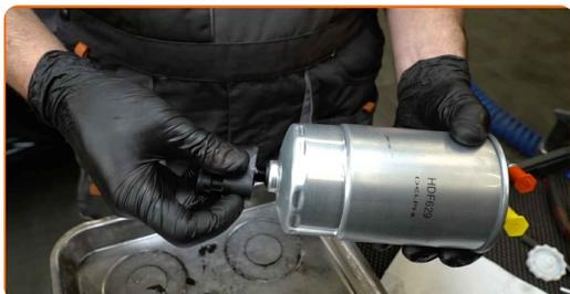
**12** Bringen Sie den Anschluss des Kraftstoffdrucksensors an.
