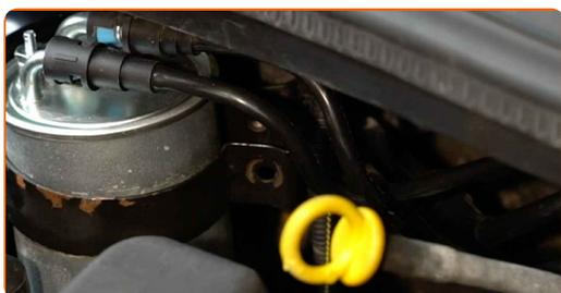
**5** Entfernen Sie den Kraftstofffilter.
