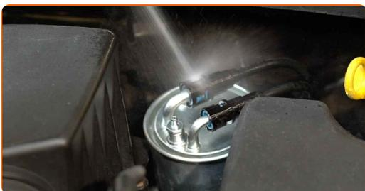
**7** Trennen Sie die Kraftstoffversorgungsleitungen vom Kraftstofffilter. Verwenden Sie Kraftstoffleitungszangen.
