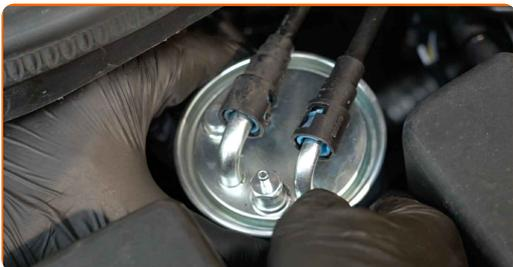
**6** Reinigen Sie die Befestigungen der Kraftstoff-Zuleitungen. Verwenden Sie Allzweckreinigungsspray.
