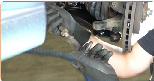
**12** Reinigen Sie die Montagesitze des Spurstangenkopfes. Benutzen Sie eine Drahtbürste. Benutzen Sie WD-40-Spray.
