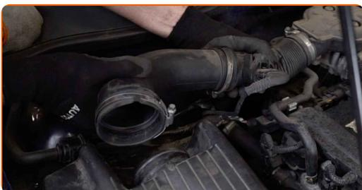
**23** Verbinden Sie das Luftansaugrohr mit dem Luftfilter-Gehäuse.
