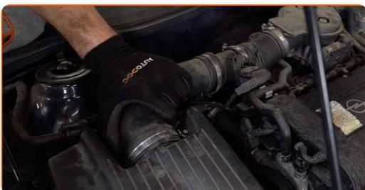
**24** Ziehen Sie die Klemme am Luftansaugschlauch fest. Verwenden Sie Stecknuss Nr. 7. Verwenden Sie einen Ratschenschlüssel.
