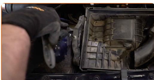
**10** Entfernen Sie das Luftfiltergehäuse.
