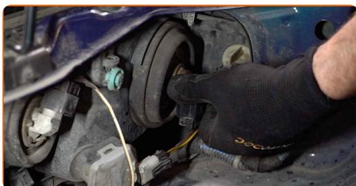
**12** Entfernen Sie die alte Glühlampe. Verwenden Sie einen flachen Schraubendreher.
