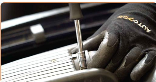
**25** Entfernen Sie die Kotflügel-Abdeckung.
