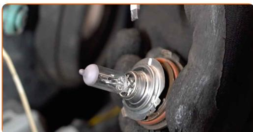
**13** Überprüfen Sie den Zustand der Kontakte der Glühlampenfassung. Tauschen Sie diese bei Bedarf aus.
