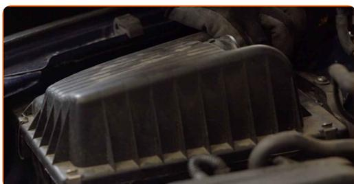
**21** Bringen Sie die Befestigungen an, die die Luftleitung und den Kabelbaum mit dem Luftfiltergehäuse verbinden.
