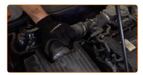
Ziehen Sie die Klemme am Luftansaugschlauch fest. Verwenden Sie Stecknuss Nr. 7. Verwenden Sie einen Ratschenschlüssel.
