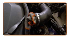
Entfernen Sie die Befestigungen, die die Luftleitung und den Kabelbaum mit dem Luftfiltergehäuse verbinden.
