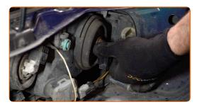
Entfernen Sie die alte Glühlampe. Verwenden Sie einen flachen Schraubendreher.
