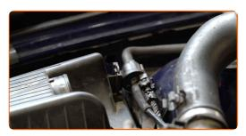
Entfernen Sie das Mikrofasertuch vom Luftansaugschlauch.
