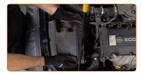
Schrauben Sie die Filtergehäuse-Befestigungsbolzen ab. Verwenden Sie den Torx T30. Verwenden Sie einen Ratschenschlüssel.
