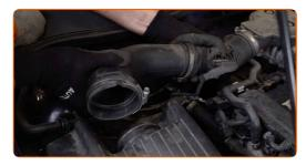
Verbinden Sie das Luftansaugrohr mit dem Luftfilter-Gehäuse.
