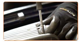
Entfernen Sie die Kotflügel-Abdeckung.
