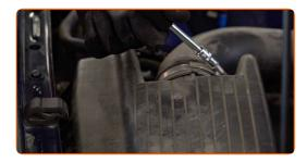
Trennen Sie das Luftansaugrohr vom Luftfilter-Gehäuse.
