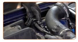
Nehmen Sie den Filterdeckel ab. Entfernen Sie das Filterelement aus dem Filtergehäuse.
