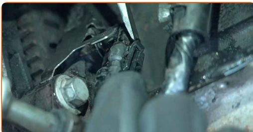
**4** Drücken Sie auf die Haltefeder des Kurbelwellensensors. Verwenden Sie einen Montagehebel.
