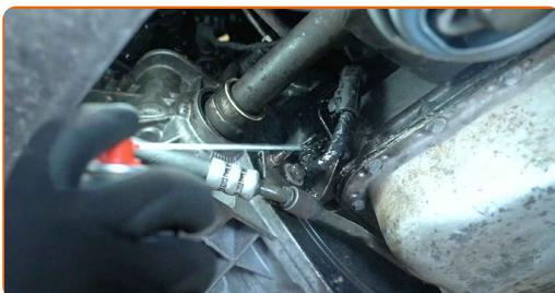
**3** Ziehen Sie den Stecker des Kurbelwellensensors ab. Verwenden Sie einen Montagehebel.
