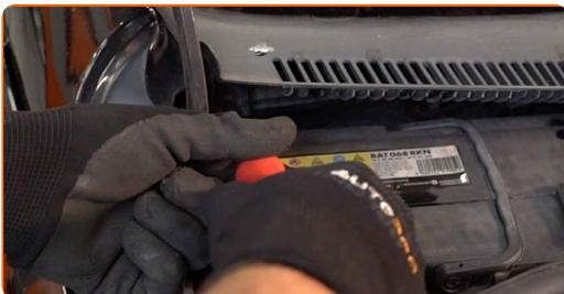
**4** Entfernen Sie die Dichtung der Windabweiserabdeckung.
