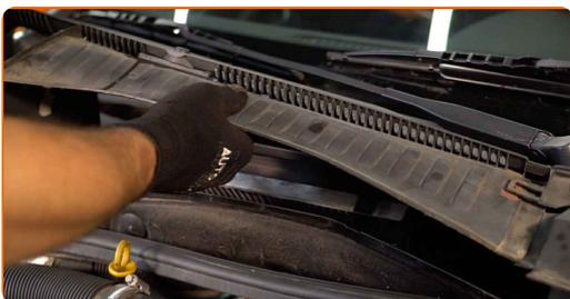
**6** Reinigen Sie den Montagesitz des Innenraumfilters.
