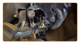
Den Halteclip des Bremsschlauchs anbringen. Verwenden Sie einen Gummi-Hammer.
