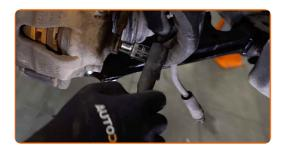
Bringen Sie den Dichtring am neuen Bremsschlauch an.
