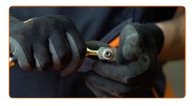
Entfernen Sie den Schmutz von der Schraube zur Befestigung des Bremsschlauchs. Benutzen Sie einen Bremsenreiniger.
