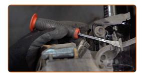
Lösen Sie den Bremsschlauch vom Federbein.
