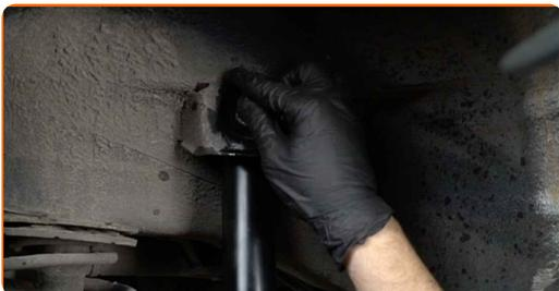
**16** Schrauben Sie das obere Befestigungselement des Stoßdämpfers ein. Verwenden Sie Stecknuss Nr. E18. Verwenden Sie einen Ratschenschlüssel.
