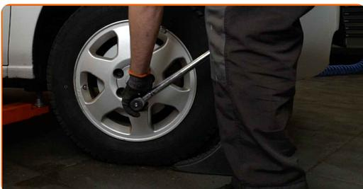
**62** Entfernen Sie den Wagenheber sowie die Unterlegkeile.
