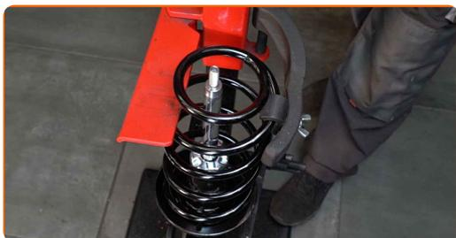
**38** Bringen Sie das Stützlager, die Manschette und den Anschlagpuffer auf dem Stoßdämpfer an.
