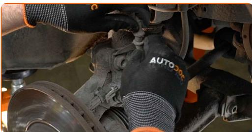
**19** Reinigen Sie die Befestigungselemente, die den Bremsschlauch mit dem Federbein verbinden. Benutzen Sie eine Drahtbürste. Benutzen Sie WD-40-Spray.
