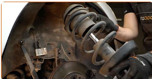
**29** Stellen Sie das Dämpferbein auf das Federspannwerkzeug.
