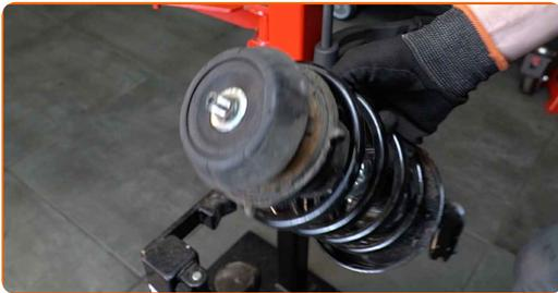
42 Installieren Sie das Federbein am Radlauf.
