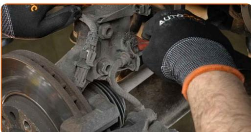
**20** Behandeln Sie die Halteklammer des Bremsschlauchs. Verwenden Sie Zangen.
