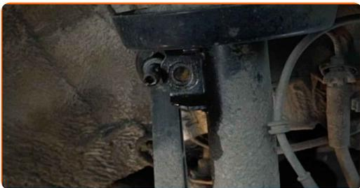
**18** Trennen Sie die ABS Sensorverdrahtung.
