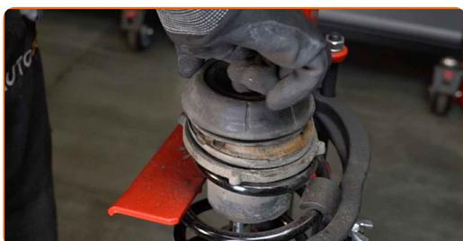
**39** Ziehen Sie die Federbeinkolbenstangenmutter an. Verwenden Sie Stecknuss Nr. 18. Verwenden Sie Inbusschlüssel Nr. H6. Verwenden Sie einen Drehmomentschlüssel. Ziehen Sie ihn mit 50 Nm Drehmoment fest.
