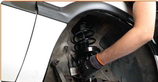
43 Schrauben Sie die obere Befestigung des Domlagers an. Schrauben Sie diese nicht fest.
