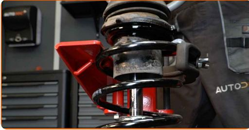
41 Entfernen Sie das zusammengebaute Federbein.
