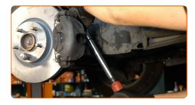
Installieren Sie die Staubschutzkappen der Bremssattel-Führungsstifte.
