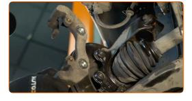
16 Entfernen Sie die Bremsscheibe.
