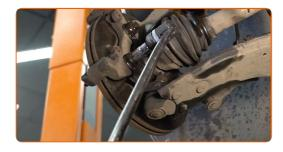
15 Entfernen Sie die Sattelhalterung.
