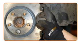
Bauen Sie die Bremssattel-Haltefeder ein. Verwenden Sie Inbusschlüssel Nr. H7. Verwenden Sie einen Ratschenschlüssel.
