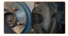
Ziehen Sie die Bremssattelbefestigungen fest. Verwenden Sie Inbusschlüssel Nr. H7. Verwenden Sie einen Drehmomentschlüssel. Ziehen Sie ihn mit 28 Nm Drehmoment fest.
