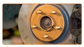
Die Bremsscheibenoberfläche reinigen. Benutzen Sie einen Bremsenreiniger.
