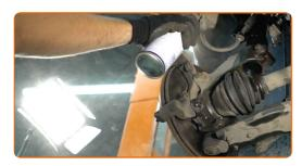
Lösen Sie die Befestigung der Sattelhalterung. Verwenden Sie Stecknuss Nr. 15. Verwenden Sie einen Ratschenschlüssel. Verwenden Sie ein Windeisen.
