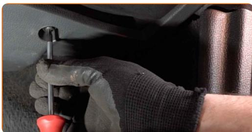
**3** Entfernen Sie die Schutzabdeckung unter dem Handschuhfach. Verwenden Sie einen Zierleistenkeil.
