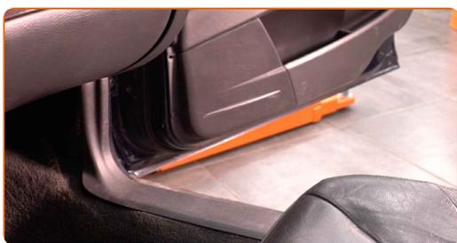
**2** Drehen Sie die Befestigungen der Einstiegsverkleidung im Fahrgastbereich auf. Verwenden Sie einen Kreuzschlitzschraubendreher.
