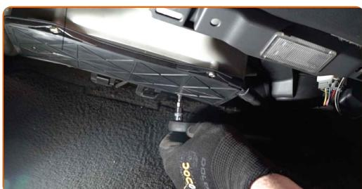
**5** Entfernen Sie den Gehäusedeckel des Innenraumfilters.
