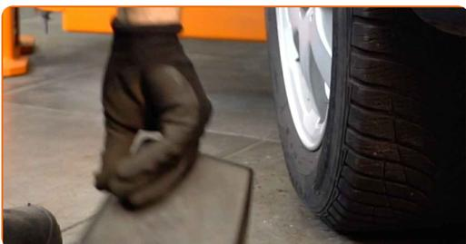
**59** Entfernen Sie die Kotflügel-Abdeckung.
