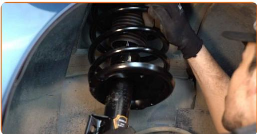
**39** Schrauben Sie die obere Befestigung des Domlagers an. Schrauben Sie diese nicht fest.
