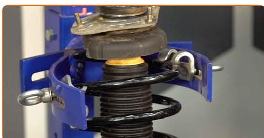
**37** Entfernen Sie das zusammengebaute Federbein.
