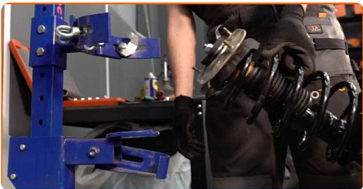
**38** Installieren Sie das Federbein am Radlauf.
