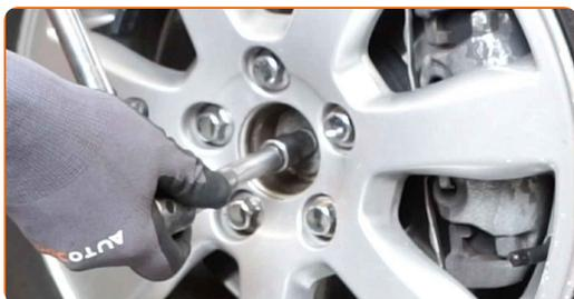
**9** Lockern Sie die Radschrauben. Verwenden Sie eine Schlagnuss für Felgen # 19. Verwenden Sie ein Windeisen.
