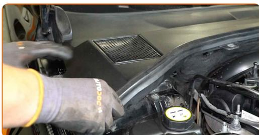
**83** Entfernen Sie die Kotflügel-Abdeckung.
