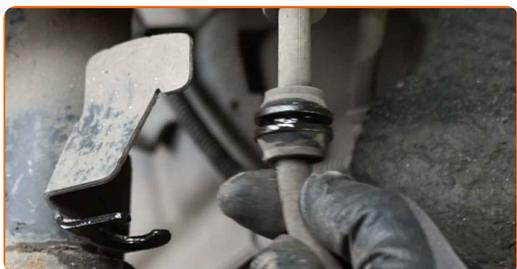
**14** Trennen Sie die Verkabelung des ABS-Sensors.
