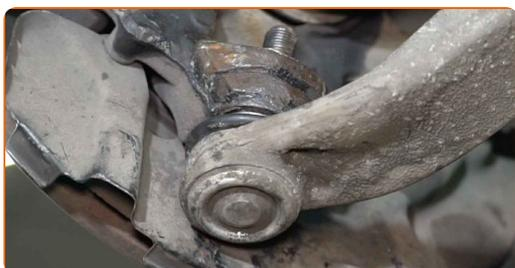
**62** Schrauben Sie das Befestigungselement ein, das das Kugelgelenk mit dem Achsschenkel verbindet.
