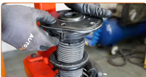
**48** Schrauben Sie die Kolbenstangenmutter des Federbeins fest. Verwenden Sie eine 18 mm Schienenmutterstecknuss. Verwenden Sie Inbusschlüssel Nr. H6. Verwenden Sie einen Drehmomentschlüssel. Ziehen Sie ihn mit 50 Nm Drehmoment fest.
