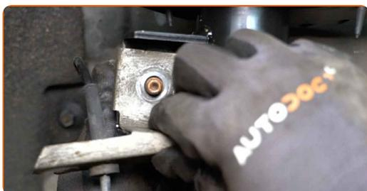
**66** Schrauben Sie die Befestigung ein, die die Koppelstange mit dem Federbein verbindet. Verwenden Sie Stecknuss Nr. 15. Verwenden Sie einen Ratschenschlüssel.
