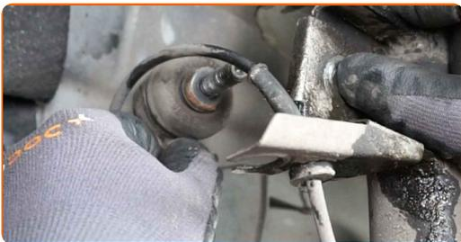
**18** Reinigen Sie die untere Befestigung, die das Federbein mit dem Achsschenkel verbindet. Benutzen Sie eine Drahtbürste. Benutzen Sie WD-40-Spray.
