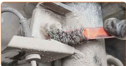
**16** Schrauben Sie das Befestigungselement heraus, das die Druckstange mit dem Federbein verbindet. Verwenden Sie Stecknuss Nr. 15. Verwenden Sie einen Ratschenschlüssel.
