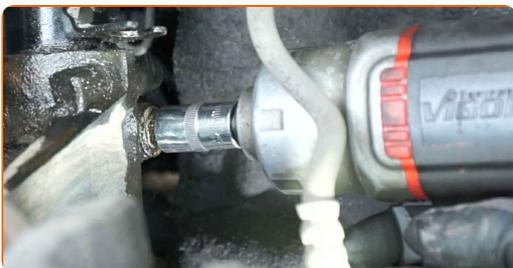
**20** Entfernen Sie die Befestigungsschraube.
