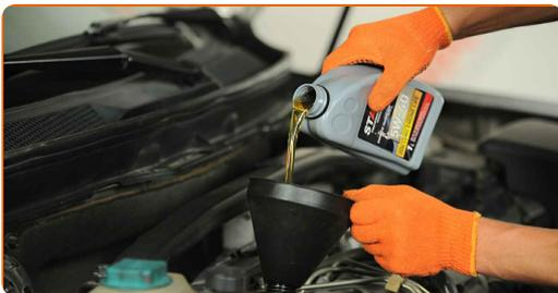
Austausch: Motoröl und Ölfilter – VOLVO V40 Schrägheck (525, 526).
