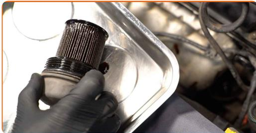
Austausch: Motoröl und Ölfilter – VOLVO V40 Schrägheck (525, 526). Tipp von AUTODOC-Experten:
