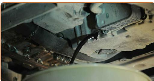
**Austausch: Motoröl und Ölfilter – VOLVO V40 Schrägheck (525, 526). Tipp:**
