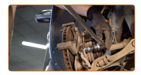
15 Entfernen Sie die Sattelhalterung.
