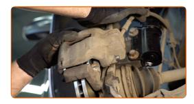
Installieren Sie die Staubschutzkappen der Bremssattel-Führungsstifte.
