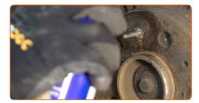
Lösen Sie die Befestigung der Bremsscheibe. Verwenden Sie Stecknuss Nr. 10. Verwenden Sie einen Ratschenschlüssel.
