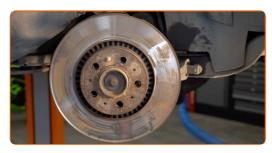
Die Bremsscheibenoberfläche reinigen. Benutzen Sie eine Drahtbürste. Benutzen Sie WD-40-Spray.
