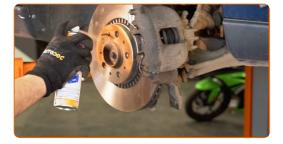
Die Bremsscheibenoberfläche reinigen. Benutzen Sie einen Bremsenreiniger.
