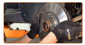
Ziehen Sie die Befestigung der Bremsscheibe fest. Verwenden Sie Stecknuss Nr. 10. Verwenden Sie einen Drehmomentschlüssel. Ziehen Sie ihn mit 9 Nm Drehmoment fest.
