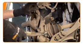
Befestigen Sie die Bremssattelhalterung. Verwenden Sie Stecknuss Nr. 15. Verwenden Sie einen Drehmomentschlüssel. Ziehen Sie ihn mit 100 Nm Drehmoment fest.
