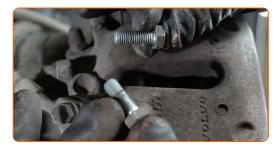
12 Entfernen Sie den Bremssattel.
