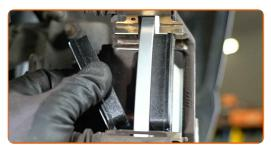
Bauen Sie den Bremssattel ein und befestigen Sie diesen.
