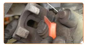
Drücken Sie den Bremssattelkolben ein. Verwenden Sie den Bremskolbenrücksteller.
