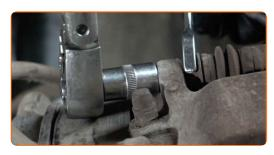
Entfernen Sie die Befestigungsschrauben.
