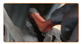
Schrauben Sie die Befestigungen des Bremssattels ab. Verwenden Sie Ring-Gabelschlüssel Nr. 15. Verwenden Sie Stecknuss Nr. 13. Verwenden Sie einen Ratschenschlüssel.
