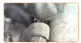
Ziehen Sie die Bremssattelbefestigungen fest. Verwenden Sie Ring-Gabelschlüssel Nr. 15. Verwenden Sie Stecknuss Nr. 13. Verwenden Sie einen Drehmomentschlüssel. Ziehen Sie ihn mit 35 Nm Drehmoment fest.
