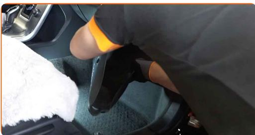
**3** Biegen Sie den Bodenbelag auf der Beifahrerseite zurück.
