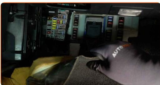
**4** Drehen Sie die Befestigungen der Einstiegsverkleidung im Fahrgastbereich auf. Verwenden Sie den Torx T25.
