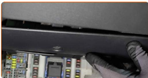
**23** Schrauben Sie die Befestigungen der Einstiegsverkleidung im Fahrgastbereich ein. Verwenden Sie den Torx T25.
