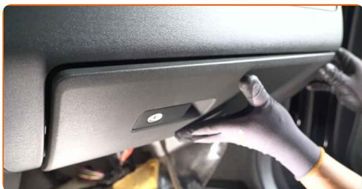
**18** Schrauben Sie die Befestigungsschrauben des Handschuhfachs ein. Verwenden Sie den Torx T25. Verwenden Sie Stecknuss Nr. 8. Verwenden Sie einen Ratschenschlüssel.
