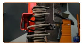
Entfernen Sie die Federbeinlagerkappe. Verwenden Sie einen flachen Schraubendreher.
