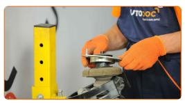
Ziehen Sie die Federbeinkolbenstangenmutter an. Verwenden Sie Ring-Gabelschlüssel Nr. 21. Verwenden Sie den Torx T50. Verwenden Sie einen Drehmomentschlüssel. Ziehen Sie ihn mit 70 Nm Drehmoment fest.
