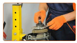
Entfernen Sie das zusammengebaute Federbein.
