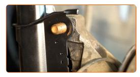
Ziehen Sie die unteren Befestigungen an, die das Federbein mit dem Achsschenkel verbinden. Verwenden Sie Ring-Gabelschlüssel Nr. 18. Verwenden Sie Stecknuss Nr. 21. Verwenden Sie einen Drehmomentschlüssel. Ziehen Sie ihn mit 105 Nm Drehmoment fest.+75°
