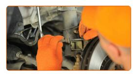
Entfernen Sie die Befestigungsschrauben.
