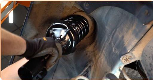
**43** Schrauben Sie die obere Befestigung des Federbeinbefestigung an. Verwenden Sie Stecknuss Nr. 13. Schrauben Sie diese nicht fest.
