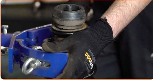
**41** Entfernen Sie das zusammengebaute Federbein.
