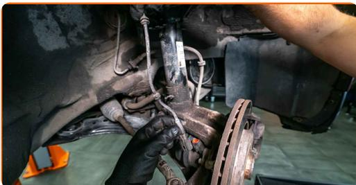
**11** Lösen Sie das Befestigungselement, welches die Antriebswelle mit der Radnabe verbindet. Benutzen Sie eine 1-3/16" 12-Kant-Nuss.
