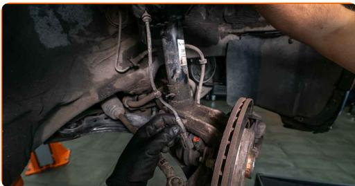
**48** Reinigen Sie die Oberfläche an welcher die Felge montiert werden soll. Benutzen Sie eine Drahtbürste. Behandeln Sie die Kontaktfläche. Benutzen Sie ein Kupferschmiermittel.
