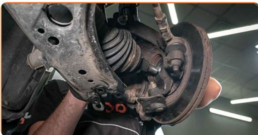
**44** Verbinden Sie das Kugelgelenk mit dem Lenker.
