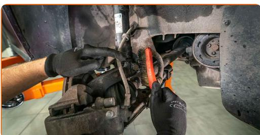
**13** Lösen Sie das Befestigungselement, welches das Kugelgelenk am Federungsquerlenker befestigt. Verwenden Sie Stecknuss Nr. 13.
