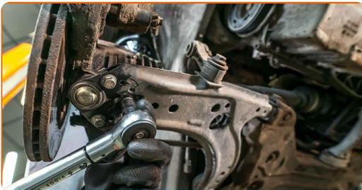
**46** Schrauben Sie die Mutter an die Gelenkwelle.
