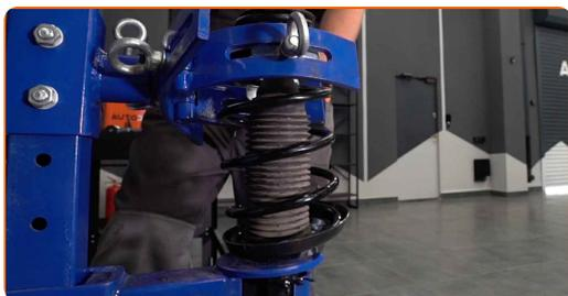
**35** Entfernen Sie das zusammengebaute Federbein.
