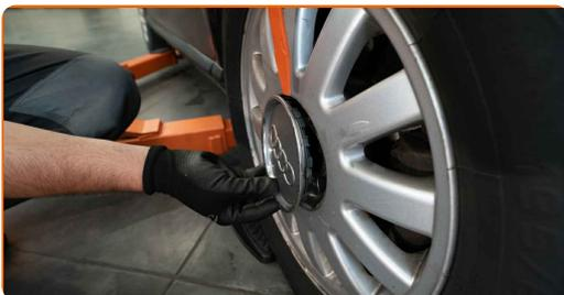
**5** Schrauben Sie die Nabenkontermutter ab. Benutzen Sie eine 1-3/16" 12-Kant-Nuss.
