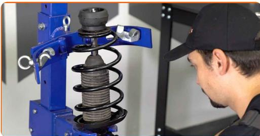
**36** Installieren Sie das Federbein am Radlauf.
