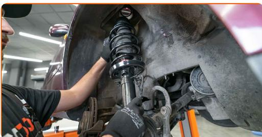
**37** Ziehen Sie die obere Befestigungsmutter des Dämpferbeins heraus. Schrauben Sie diese nicht fest.
