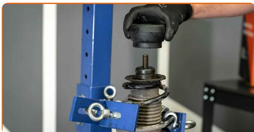
**33** Ziehen Sie die Federbeinkolbenstangenmutter an. Verwenden Sie die geschlitzte Stecknuss # 22. Verwenden Sie Inbusschlüssel Nr. H6. Verwenden Sie einen Drehmomentschlüssel. Ziehen Sie ihn mit 60 Nm Drehmoment fest.
