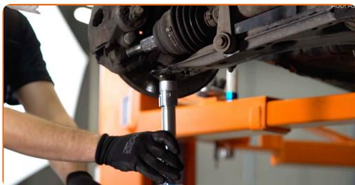
**17** Schrauben Sie das untere Befestigungselement ab, das das Federbein mit dem Achsschenkel verbindet. Verwenden Sie Ring-Gabelschlüssel Nr. 18. Verwenden Sie Stecknuss Nr. 18.
