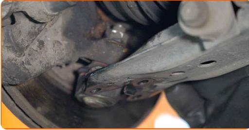
**45** Schrauben Sie die Befestigungen der Kugelgelenksplatte fest (3 Stück). Achtung! Verwenden Sie unbedingt neue Befestigungen. Verwenden Sie Stecknuss Nr. 13. Verwenden Sie einen Drehmomentschlüssel. Ziehen Sie ihn mit 20 Nm Drehmoment fest.+90°
