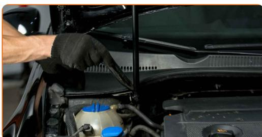
**27** Reinigen Sie die Befestigungselemente der oberen Federbeinhalterung. Benutzen Sie WD-40-Spray.
