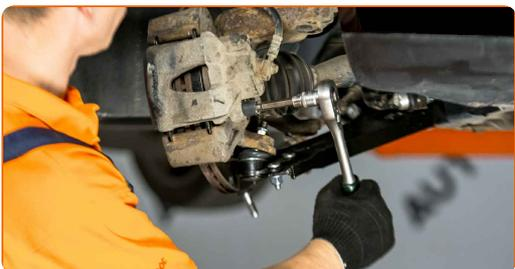
**11.2** Verwenden Sie Inbusschlüssel Nr. H7. Verwenden Sie einen Ratschenschlüssel.
