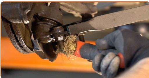
**14.1** Schrauben Sie die Kugelgelenkbefestigung vom Achsschenkel ab.
