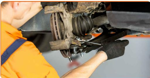
**50** Ziehen Sie das Kugelgelenk an. Verwenden Sie Ring-Gabelschlüssel Nr. 19. Verwenden Sie einen Drehmomentschlüssel. Ziehen Sie ihn mit 60 Nm Drehmoment fest.
