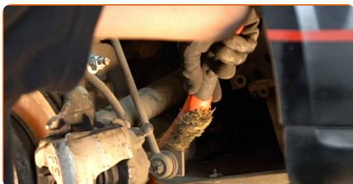
**21.1** Schrauben Sie die Mutter ab und entfernen Sie die Stabilisatorstange aus dem Federbein.
