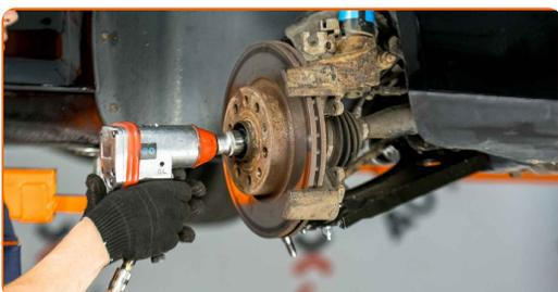
**53** Montieren Sie den Querlenker. Ziehen Sie das Befestigungselement an, das die Druckstange mit dem Federbein verbindet. Verwenden Sie Stecknuss Nr. 19. Verwenden Sie einen Drehmomentschlüssel. Ziehen Sie ihn mit 60 Nm Drehmoment fest.
