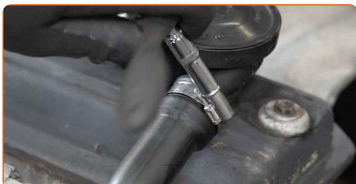
**42** Entfernen Sie den Kurbelgehäuse-Entlüftungsschlauch.
