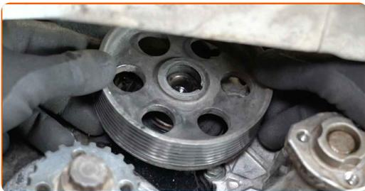
**56** Lösen Sie die Befestigungselemente der hydraulischen Servopumpe. Verwenden Sie Stecknuss Nr. 13. Verwenden Sie Stecknuss Nr. 16. Verwenden Sie einen Ratschenschlüssel.
