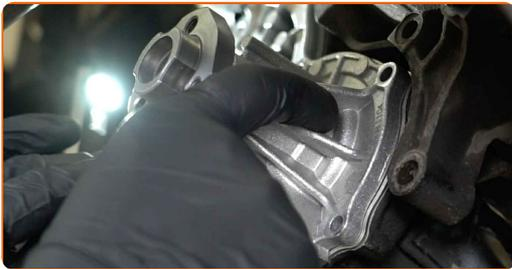
**68** Schrauben Sie die Befestigungen der Wasserpumpe fest. Verwenden Sie Stecknuss Nr. 10. Verwenden Sie einen Drehmomentschlüssel. Halten Sie das empfohlene Anzugsdrehmoment ein.
