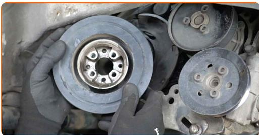
**32** Reinigen Sie das Befestigungselement der Wasserpumpenriemenscheibe. Benutzen Sie eine Drahtbürste. Verwenden Sie Allzweckreinigungsspray.
