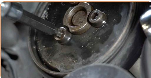
**34** Entfernen Sie die Wasserpumpenriemenscheibe.
