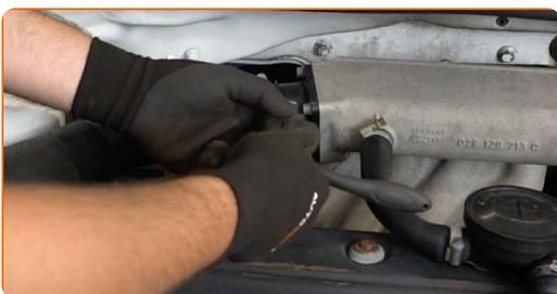
**9** Entferne die Komponenten des Lüftungskanals.
