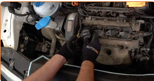
21 Entfernen Sie das Mikrofaser Tuch von der Drosselklappe.
