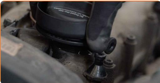
20 Verbinden Sie den Kurbelgehäuse-Entlüftungsschlauch mit dem Öleinfüllstutzen.
