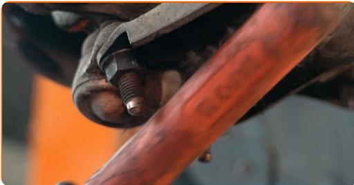
**29** Lösen Sie das Befestigungselement, welches das Kugelgelenk am Federungsquerlenker befestigt. Verwenden Sie Stecknuss Nr. 16. Verwenden Sie einen Ratschenschlüssel.
