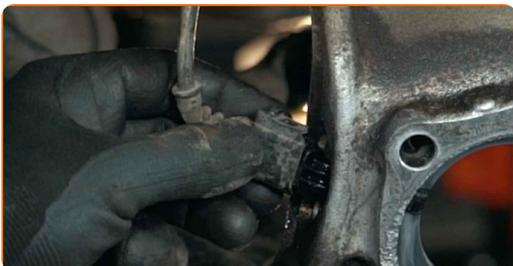
**42** Schrauben Sie die Befestigung, die den ABS-Sensor am Achsschenkel verbindet, fest. Verwenden Sie Inbusschlüssel Nr. H5. Verwenden Sie einen Drehmomentschlüssel. Ziehen Sie ihn mit 7 Nm Drehmoment fest.
