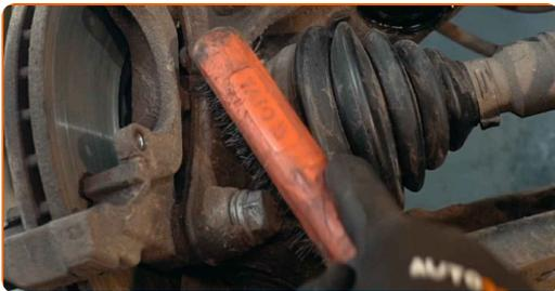
**18** Lösen Sie die Befestigung der Sattelhalterung. Verwenden Sie Stecknuss Nr. 21. Verwenden Sie einen Ratschenschlüssel. Verwenden Sie ein Windeisen.
