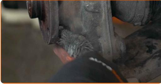
**28** Reinigen Sie die Befestigungselemente, die das Kugelgelenk mit dem Aufhängungslenker verbinden. Benutzen Sie eine Drahtbürste. Benutzen Sie WD-40-Spray.
