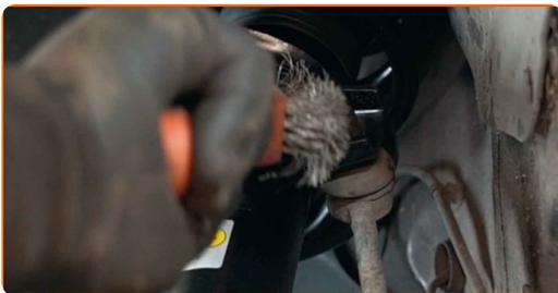
**33** Schrauben Sie das Befestigungselement heraus, das die Druckstange mit dem Federbein verbindet. Verwenden Sie Stecknuss Nr. 18. Verwenden Sie einen Ratschenschlüssel.
