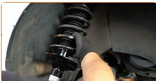
**32** Schrauben Sie die obere Befestigung des Federbeinbefestigung an. Schrauben Sie diese nicht fest.
