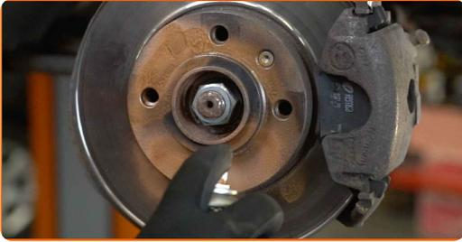
**45** Die Bremsscheibenoberfläche reinigen. Benutzen Sie einen Bremsenreiniger.
