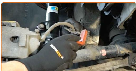
**40** Sichern Sie den Bremsschlauch-Befestigungswinkel.
