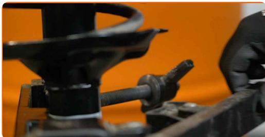
**29** Entfernen Sie das zusammengebaute Federbein.
