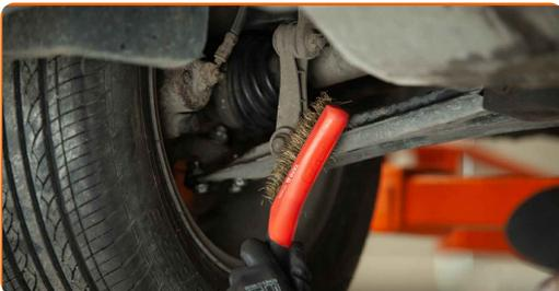
**3** Lösen Sie die Befestigungselemente, die die Koppelstange mit dem Stabilisator und dem Federbein verbinden. Verwenden Sie Ring-Gabelschlüssel Nr. 16. Verwenden Sie einen Drehmomentschlüssel.
