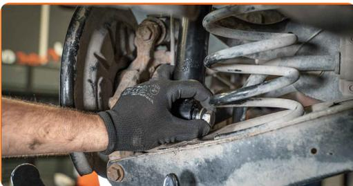
24 Entfernen Sie den Träger unter dem hinteren Arm.
