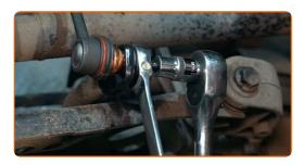
Ziehen Sie das Befestigungselement an, das die Druckstange mit dem Federbein verbindet. Verwenden Sie Ring-Gabelschlüssel Nr. 18. Verwenden Sie Stecknuss Nr. 18. Benutzen Sie den XZN #6. Verwenden Sie einen Drehmomentschlüssel. Ziehen Sie ihn mit 55 Nm Drehmoment fest.
