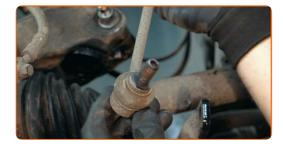
Reinigen Sie die Montagesitze der Koppelstange. Benutzen Sie eine Drahtbürste. Benutzen Sie WD-40-Spray.
