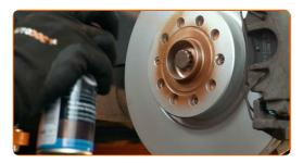
Die Bremsscheibenoberfläche reinigen. Benutzen Sie einen Bremsenreiniger.
